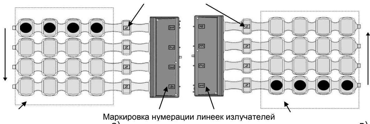
«Бегущая горизонталь», полярность магнитного поля со стороны, обращенной к Вам, – северная (маркировка полярности - N).
