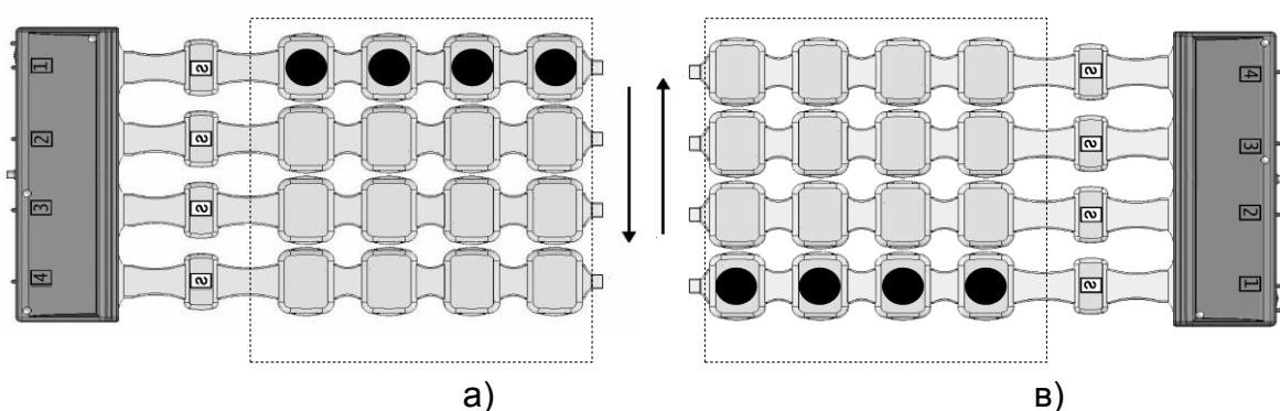
Бегущая горизонталь, полярность магнитного поля со стороны, обращенной к Вам - южная (маркировка полярности - S).
