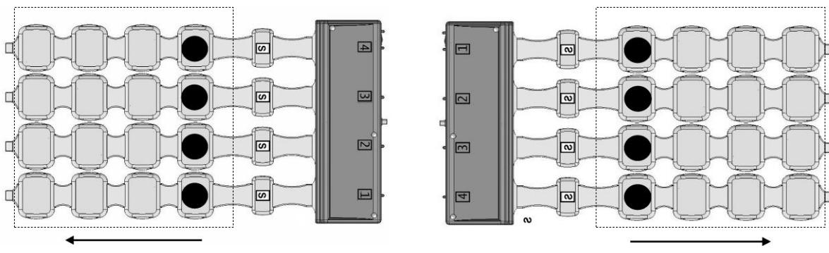
Рис.7 Бегущая вертикаль, полярность магнитного поля со стороны, обращенной к Вам, - южная (маркировка полярности -S)
