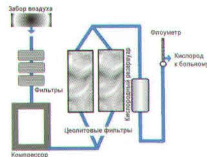
В основе принципа работы концентратора кислорода лежит физическое разделение газов из смеси газов при комнатной температуре. Для выделения кислорода из воздуха недавно был открыт этот малоэнергетичный метод, который применяется и в инкубаторах, и на сталелитейных заводах.
